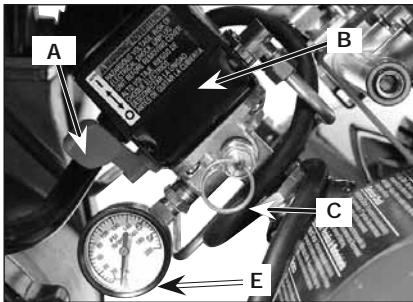
**Válvula de seguridad (C):** Si el interruptor de presión dejara de cortar el suministro de presión del compresor conforme a los valores prefijados para la presión de corte, la válvula de seguridad protegerá contra la presión elevada, "saltando" de acuerdo a los valores prefijados en fábrica (ligeramente superiores a los de presión de corte de la llave interruptora.)
