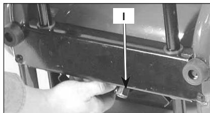
**Válvula reguladora (L):** Cuando el compresor de aire se encuentra funcionando, la válvula reguladora está "abierta", permitiendo la entrada del aire comprimido al tanque de aire. Cuando el nivel de presión del tanque alcanza el punto de "corte", la válvula reguladora "se cierra", reteniendo la presión del aire dentro del tanque.
