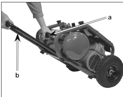
3. Tire de la unidad tal como se indica; no empuje la unidad. **NOTA:** al transportarla, no levante la unidad hasta el punto en que la misma puede caerse en posición invertida.
