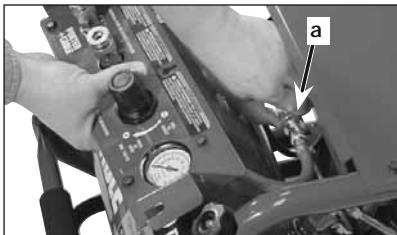
3. Connectez le boyau d'air (vendu séparément) à la fiche à connexion rapide (b) et au raccord à connexion rapide (a). La console peut alors être transportée plus près du lieu de travail pour être placée sur les supports de console (d) ou pour être monté temporairement en utilisant le trou de montage (c).
