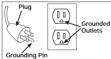
**DANGER** IMPROPER GROUNDING CAN RESULT IN ELECTRICAL SHOCK.
