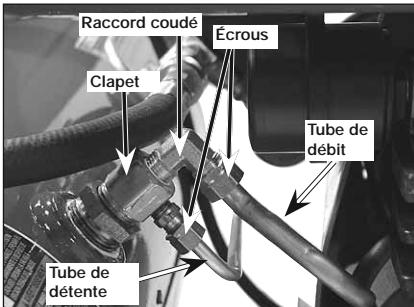
6. Dévissez le raccord coudé de la soupape de retenue (en tournant dans le sens contraire des aiguilles d'une montre) à l'aide d'une clé réglable. Notez l'orientation du raccord coudé pour faciliter la pose plus tard.
