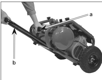
3. Tirez l'appareil tel qu'illustré ; ne pas pousser l'appareil. REMARQUE : Lors du transport, ne soulevez pas l'appareil jusqu'au point où il basculerait vers l'arrière.
