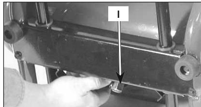
**Souape de retenue (L) :** Lorsque le compresseur fonctionne, la souape de retenue est « ouverte », permettant à l'air comprimé d'entrer dans le réservoir d'air. Quand le compresseur d'air atteint la « pression de rupture », la souape de retenue « se ferme », permettant à l'air comprimé de demeurer à l'intérieur du réservoir d'air.
