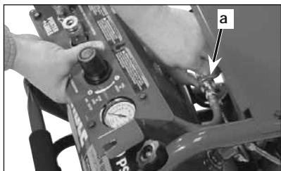
3. Conecte la manguera del aire (vendida en forma separada) al enchufe de conexión rápida (b) y al conector rápido (a). La consola podrá ser luego llevada a un punto más cercano al sitio de trabajo, y ser apoyada sobre los soportes de la consola (d) o bien ser temporalmente montada utilizando el orificio montante (c).
